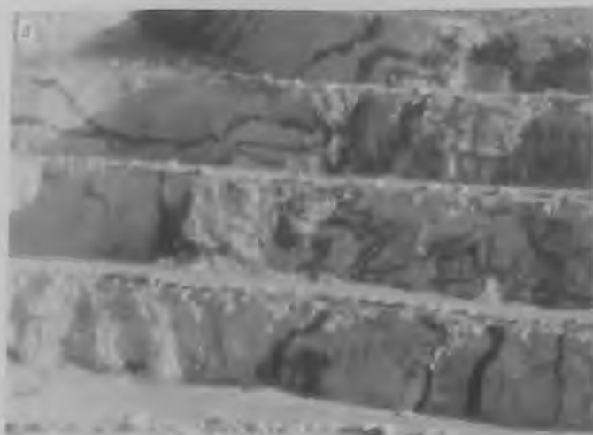
Рис. 2. Поверхность откосов уступов известнякового карьера (а) и развал горной массы (б) на карьере в Финляндии
