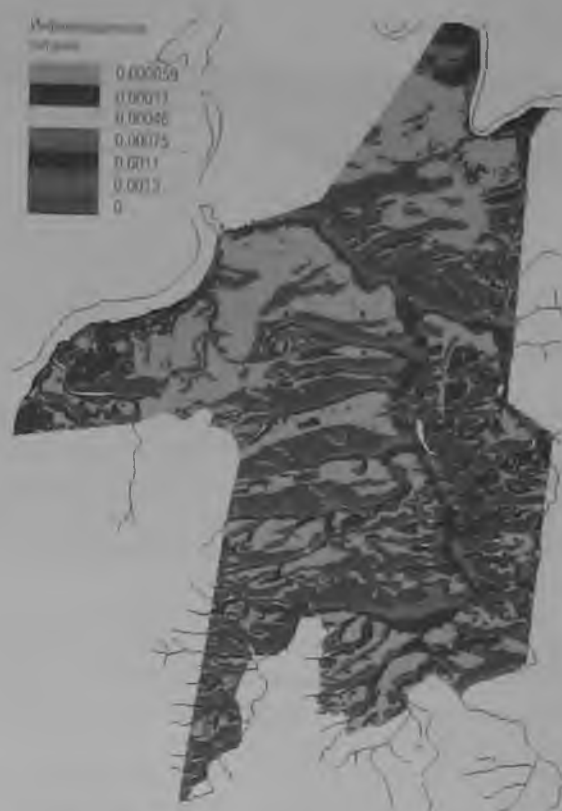
Рис. 2. Схема распределения инфильтрационного питания (м/сут), принятого в расчетной модели
