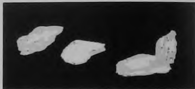
Рис. 2. Качественная оценка площади, занимаемой минералами в сподуменовом концентрате (белый цвет – поверхность, имеющая цветовую характеристику сподумена; темный – с цветовой характеристикой минералов вмещающих пород)
